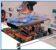
Кулер GeminII от Cooler Master волиж в буквальном смысле. Он эффективно охлаждает не только процессор, но и материнку.
