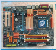
GIGABYTE снабдила новые системные платы на базе Intel P35 продвинутой системой охлаждения.
